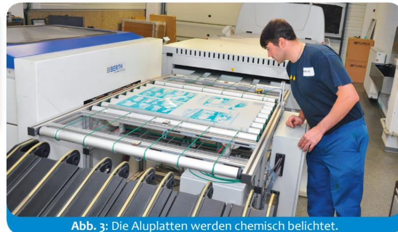
Abb. 3: Die Aluplatten werden chemisch belichtet.
